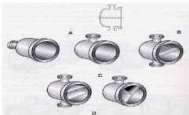
Figure I. 9: Type de chambre de distribution [5]
