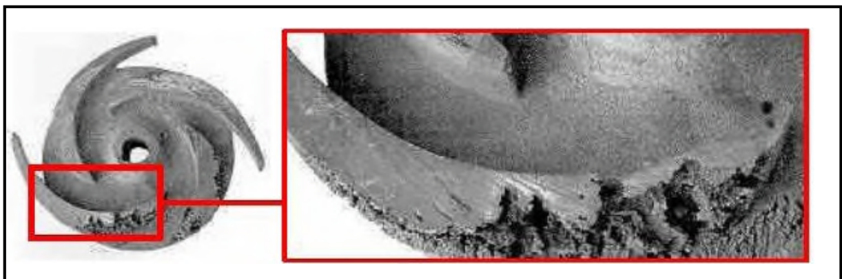
Figure VI-8. Photo illustrant le phénomène de cavitation sur les aubes d'une pompe centrifuges.
