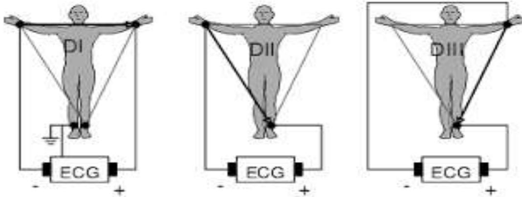
**Figure 1.12 :** Le dispositif d'enregistrement d'Einthoven [5].
