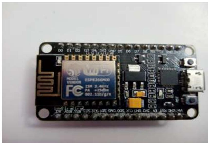
**Figure II.13 :** Vue d'ensemble Le module ESP8266.
