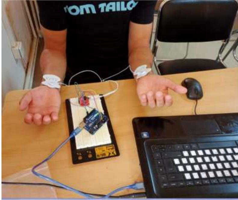
**Figure III.8:** Test d'AD8232.
