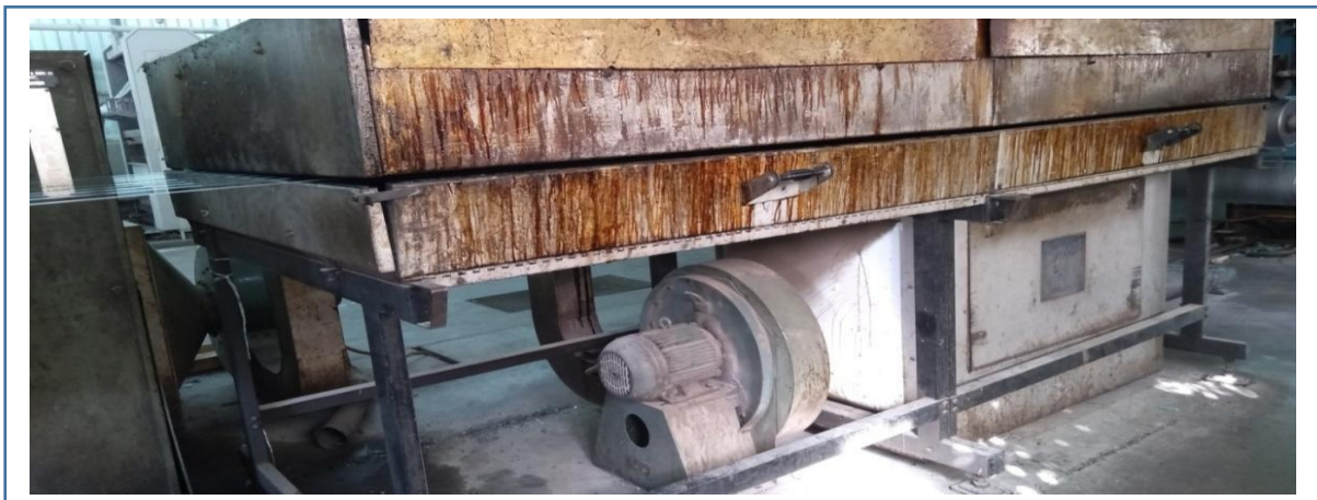
Figure I.13 : Le four électrique
