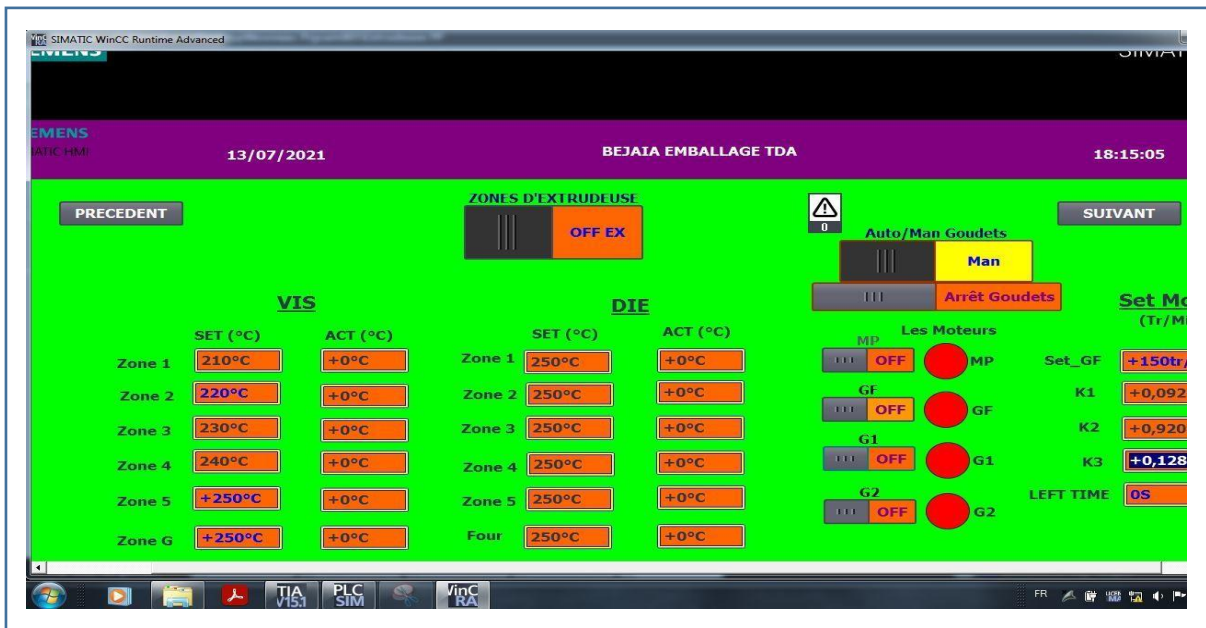
Figure III.15 : WinCC Runtime vue paramètres d'extrudeuse.
