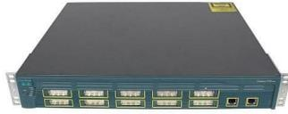
FIGURE 2.7 – Commutateur Catalyst Cisco 3550 [15].
