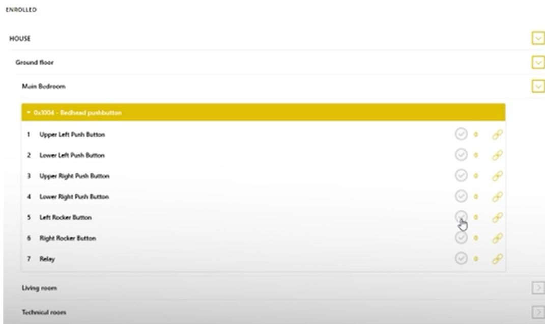
Figure IV.24. Configuration d'une application entre un bouton et un actionneur dans Vimar View pro
