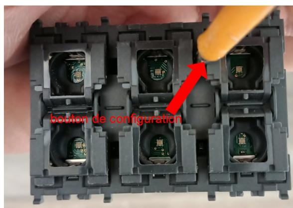
Figure IV.20. Configuration d'un bouton poussoir 3 modules
