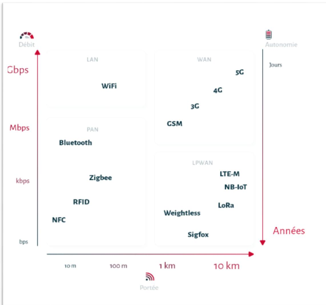
**Figure II.7 :** Comparaison des réseaux dans IoT [27].
