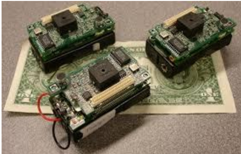
Figure1.1 : Exemple d'un nœud capteur
