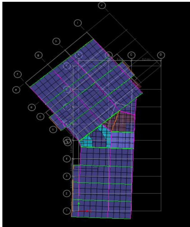
Figure IV.4. Le premier mode est un mode de translation suivant l'axe Y-Y
