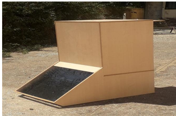
Figure 5.1: Photo réelle de notre déshydrateur solaire.
