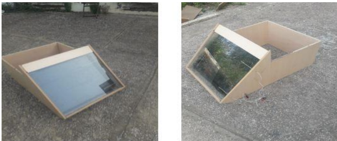
Figure 5.4 : Photo réelle du capteur solaire.
