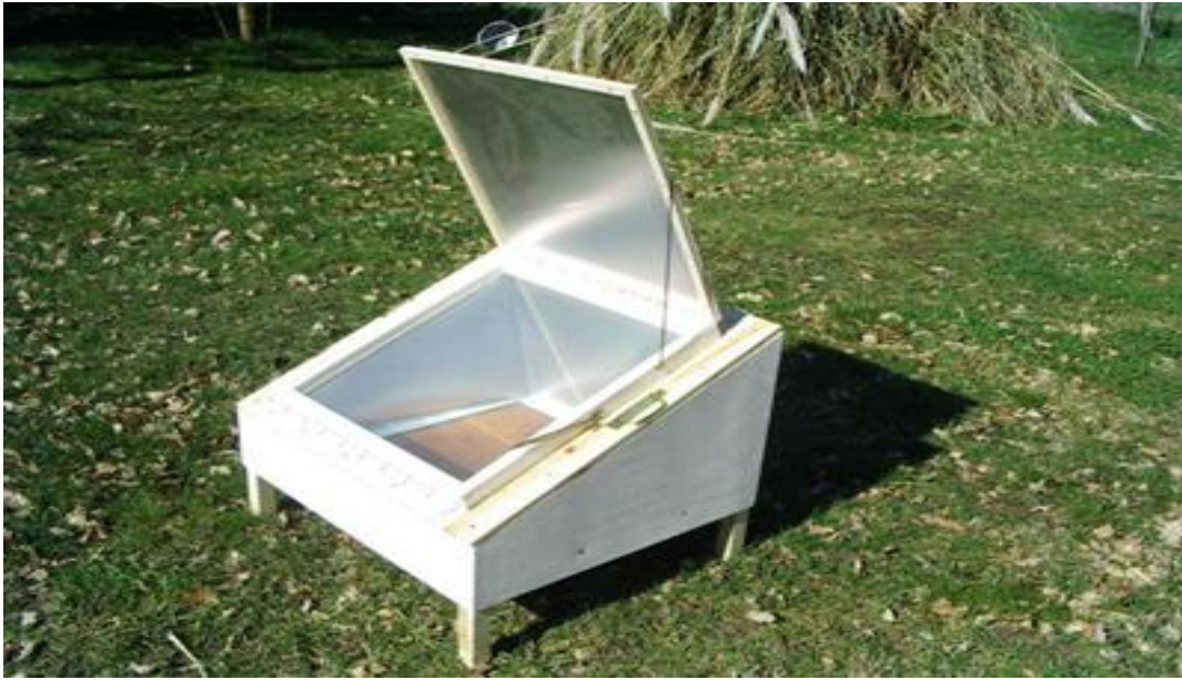
Figure 3.1: Déshydrateur solaire direct.
