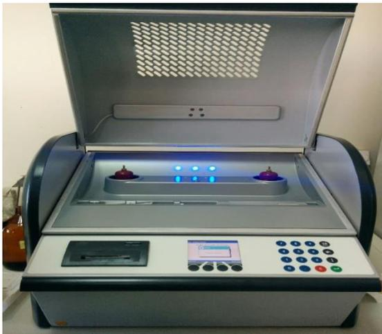
Figure IV. 7: spintermètre BAUR OIL TESTER DTA
