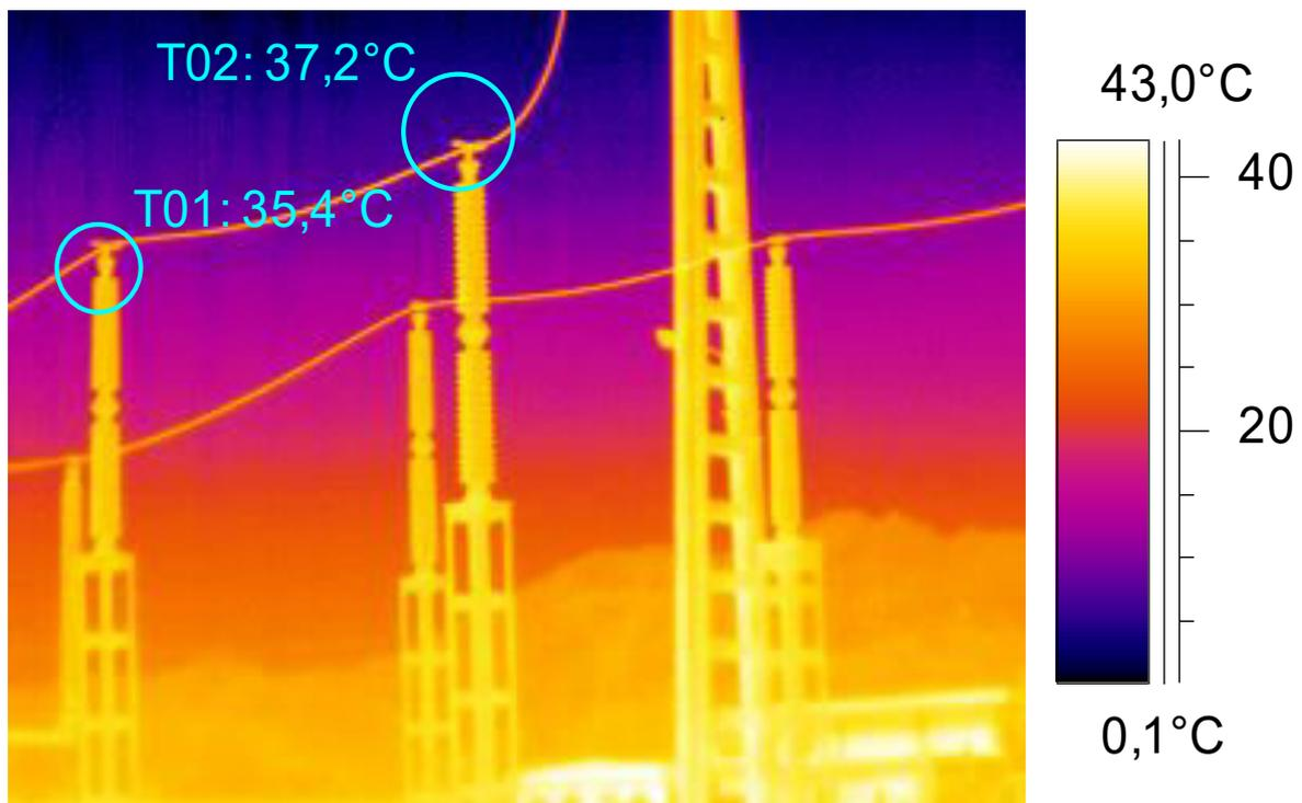
Figure IV. 19: les points de connexion HT
