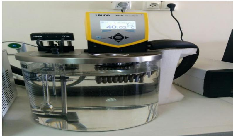
Figure IV. 9: le viscosimètre LAUDA iVisc.
