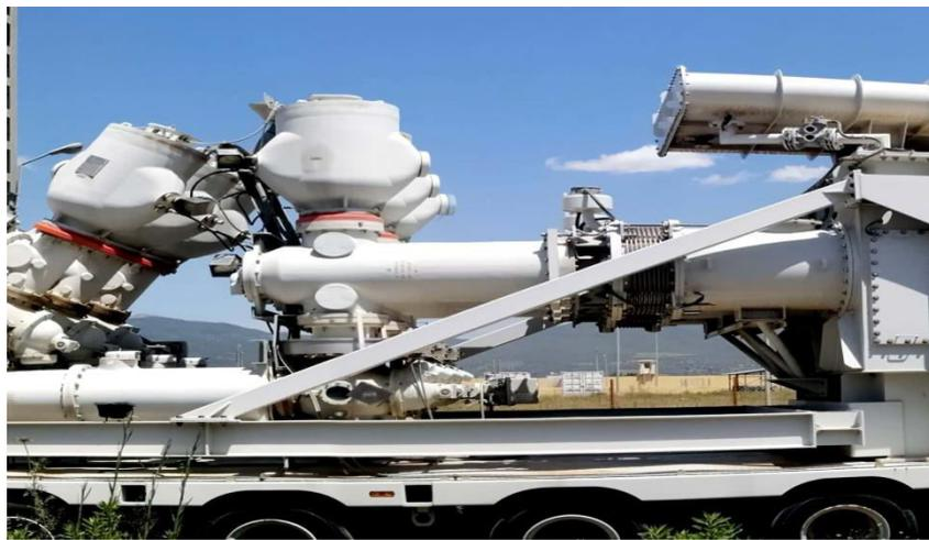
Figure IV. 14: disjoncteur ligne 220kv
