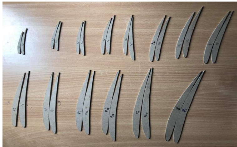
Figure III.6 : NACA 6409 en carton épais.
