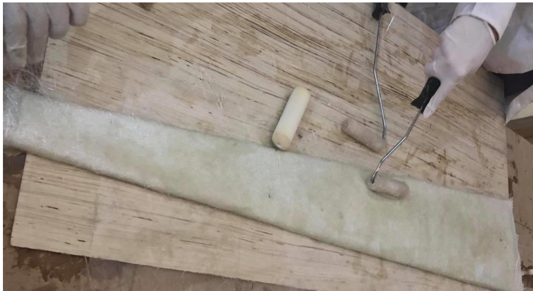
Figure III.11 : Pale en résine et fibre de verre.
