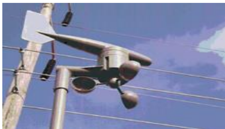
Figure I.10 : Anémomètre à coupelles sur son mât, surmonté d'une girouette.
