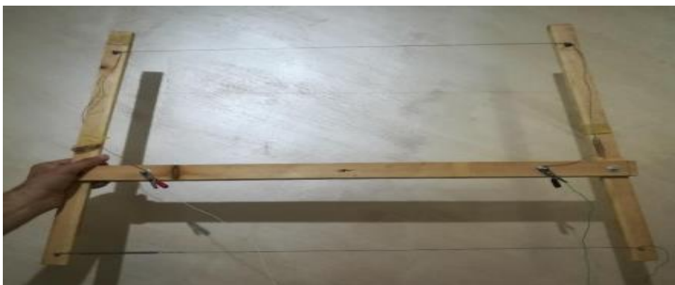
Figure III.7 : Coupe polystyrène à fil chaud.
