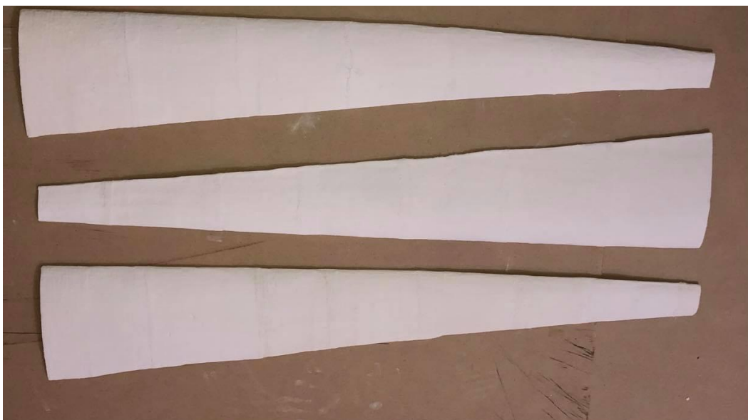
Figure III.9 : Pale recouverte d'enduit et de plâtre.
