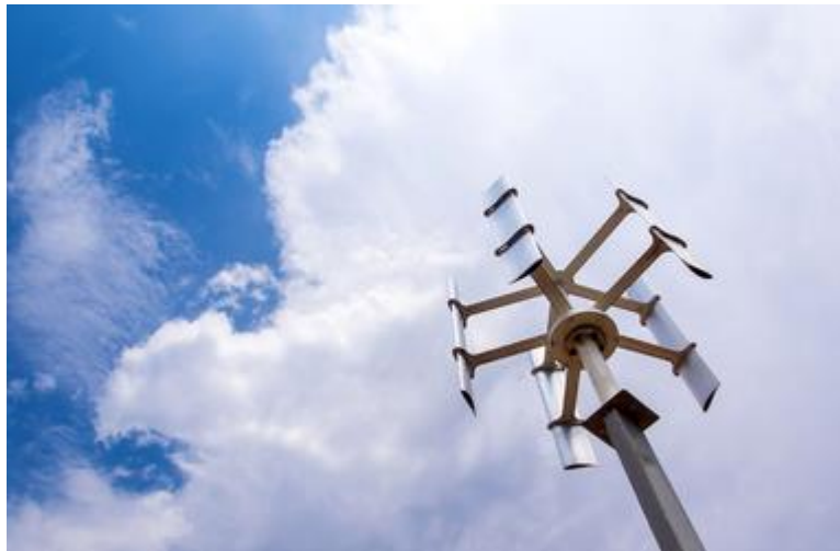
Fig.I.5 : Eolienne à axe vertical
