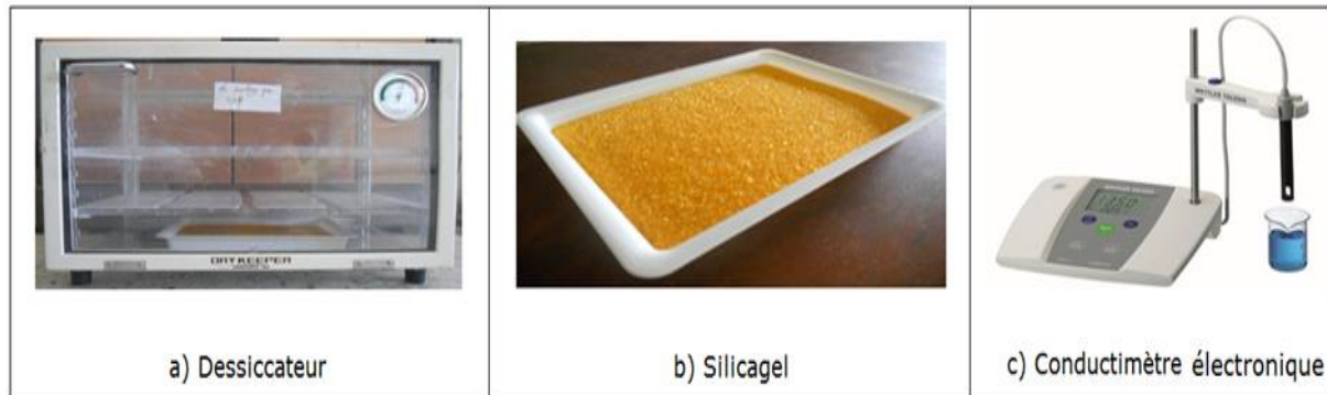
Fig. III. 4: Dessiccateur avec silicagel et conductimètre électronique
