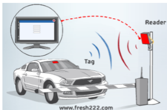
FIGURE 1.2 – Illustration du fonctionnement de la technologie RFID.[9]
