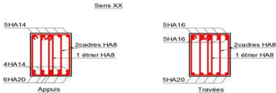
Figure .V.6. Ferrailage des nervures sens X-X.
