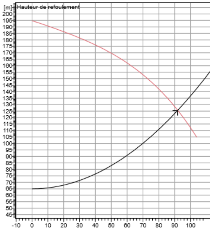
Figure V.1 : Les courbes caractéristiques de la pompe
