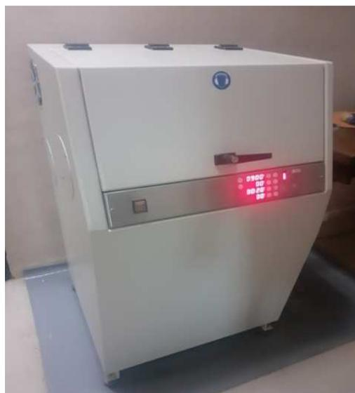
**Figure IV.4**.Broyeur à disques de laboratoire
