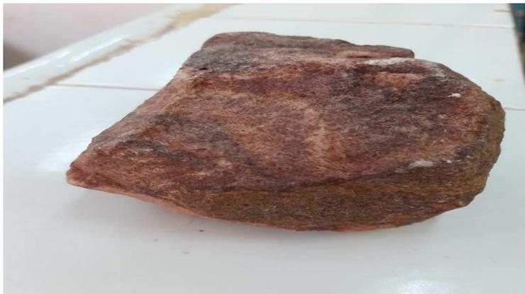
**Figure IV.1** .Echantillon représentatif de fer oolithique de GDj
