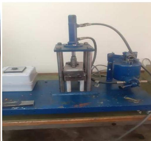
Figure IV.9. Presse hydraulique (Pastilleuse)
