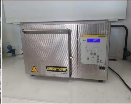
**Figure IV.6.**Four a moufle d'une capacité de 1300C°
