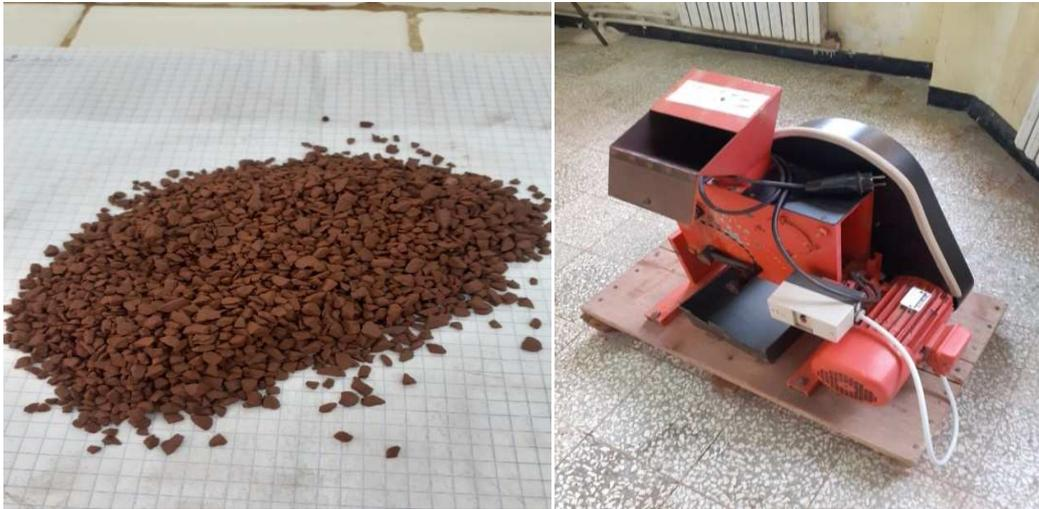
**Figure IV.2** .Echantillon après concassage.
