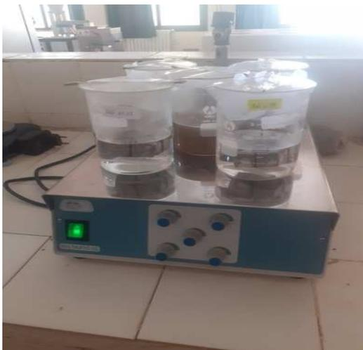
Figure IV.8..Agitateur magnétique
