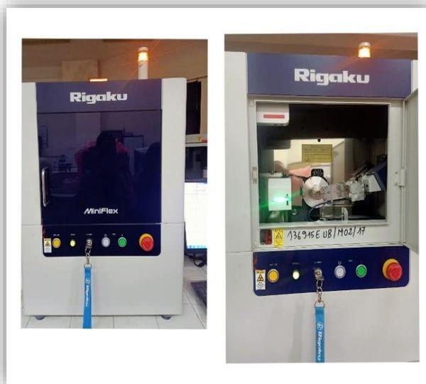
**Figure III.8:** diffractomètre à rayons X.
