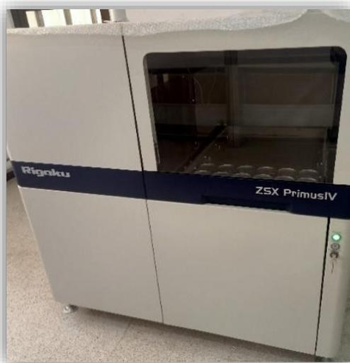
**Figure III.10:** Appareil de FX.
