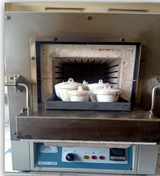
**Figure VI.13:** Four de laboratoire **SELECT-HORN** température maximale 1500°C.
