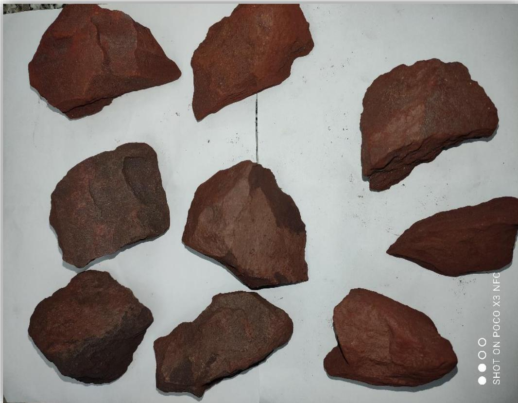
Figure III.1: Echantillon brut de minerai de fer de Gara Djebilet.
