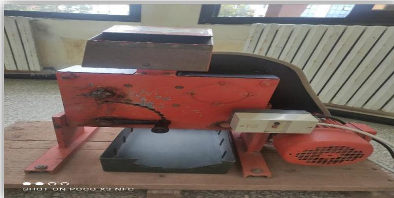
**Figure III.3:** Concasseur à mâchoire à double effet. Photo prise au laboratoire du département des Mines et Géologie.
