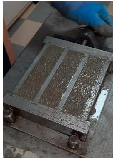
Figure 16 : Epreuves préparées sur des moules 4×4×16
