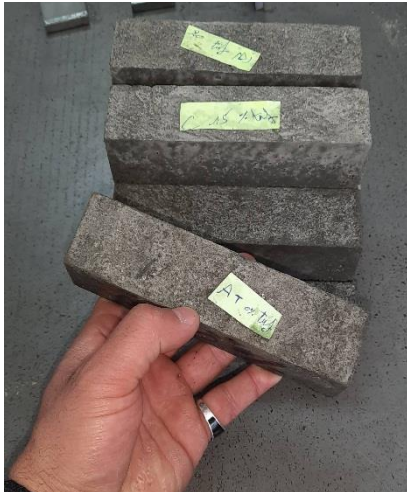
Figure 21 : éprouvettes durcies à différents âges.
