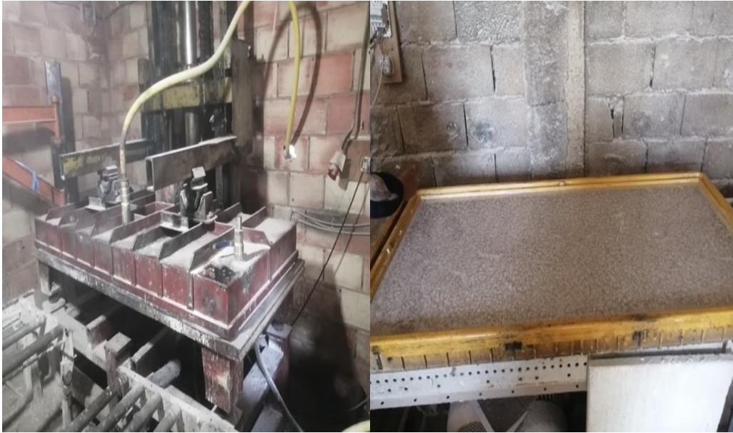
Figure 20 : Vibrateur + dalle de marbre après vibration (prise le 04/04/2021)
