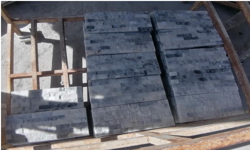
Figure 12 : Revêtement de mur en marbre (prise le 04/04/2021)
