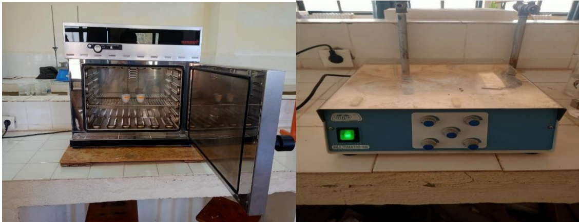
Figure 4 : la plaque agitatrice et l'étuve
