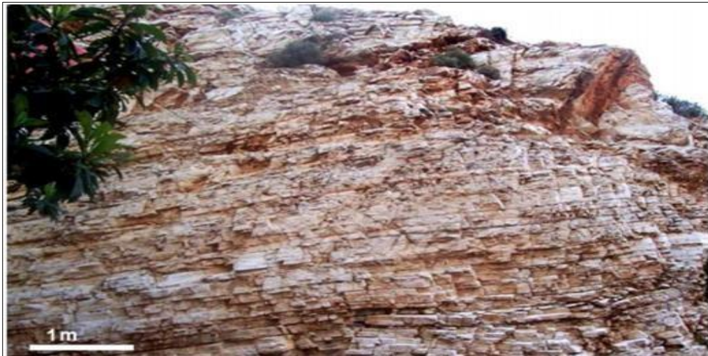
Figure. I.1. Structure géométrique d'un massif rocheux de calcaire. [1]
