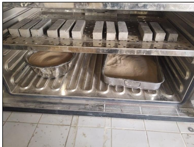
Figure 43. Séchage de brique dans l'étuve
