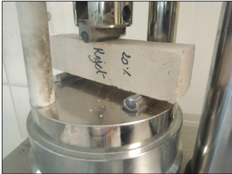
Figure.26 Essais de flexion (Laboratoire cimenterie Ain-kebira)
