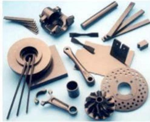
**Figure I.5 : Exemples d'applications des composites à matrice métallique [17].**
