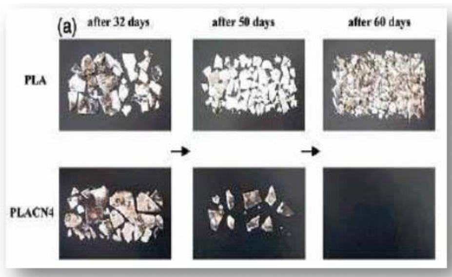
**Figure IV.1 : Dégradation accélérée d'un Polylactide (PLA) avec 4% de MMT [30].**
