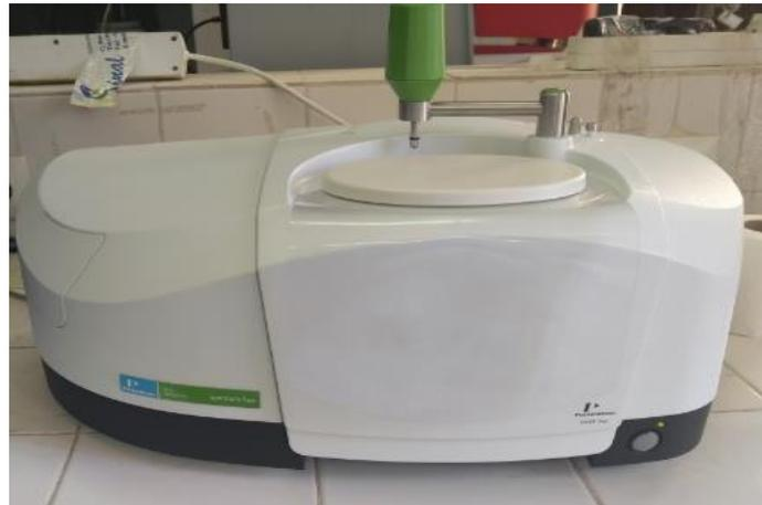
**Figure II.13.** Photographie du spectromètre infrarouge de type *Prekin Elmer « spectrum two »* (Laboratoire de physique des matériaux et catalyse, Université de Bejaia)
