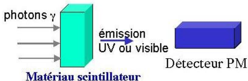
Figure I.7. Principe d'utilisation d'un matériau scintillateur [14].
