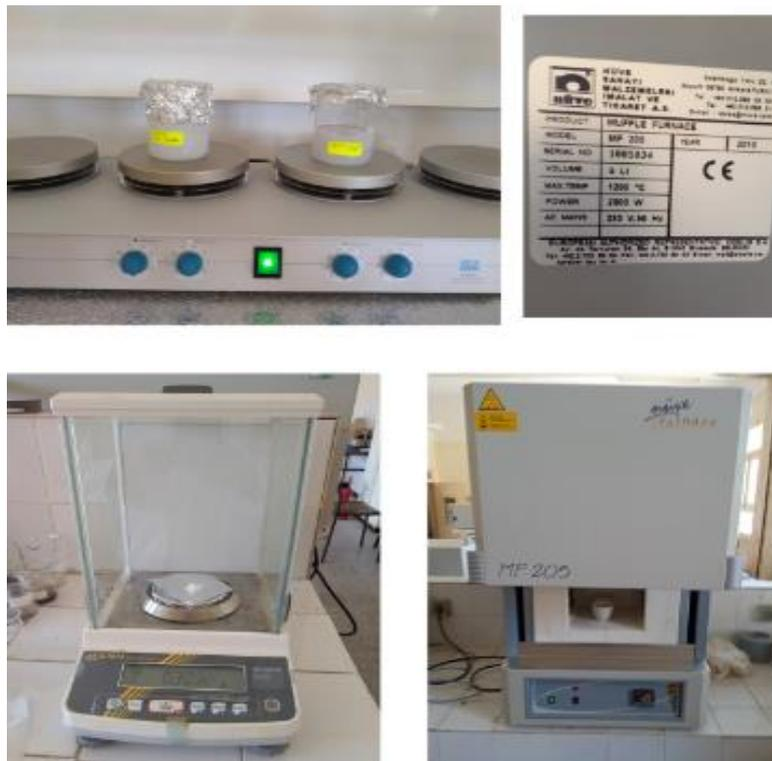
**Figure II.7.** Photographie des matériels utilisés dans la synthèse par voie sol-gel.
