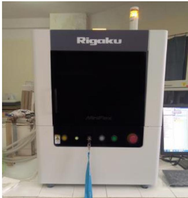
**Figure II.10.** Diffractomètre de rayons X de type *Rigaku Mini flex-II diffractometer*
