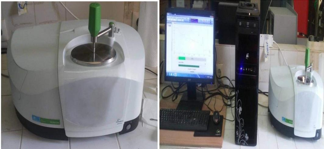
**Figure II.6 :** Un Spectromètre infrarouge à transformée de Fourier (FTIR) au laboratoire de chimie physique des matériaux et catalyse (LPCMC), université de Bejaïa
