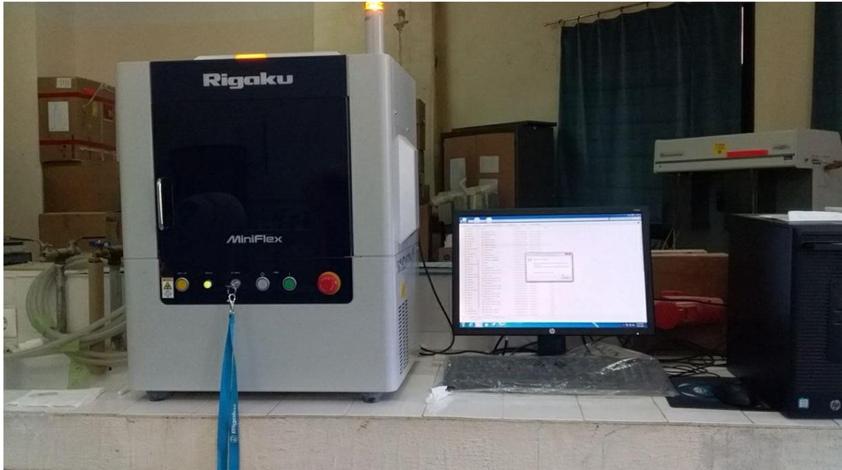
**Figure II.4 :** Un diffractomètre à rayon X de marque Rigaku MiniFlex au laboratoire de chimie physique des matériaux et catalyse (LPCMC), université de Béjaia.
