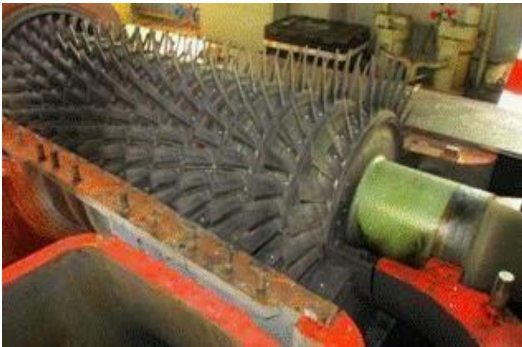
**Figure I.12 :** *Compresseur axial*
