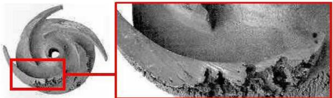
Figure (VI-2) : Photo illustrant le phénomène de cavitation sur les aubes d'une pompe centrifuge.
