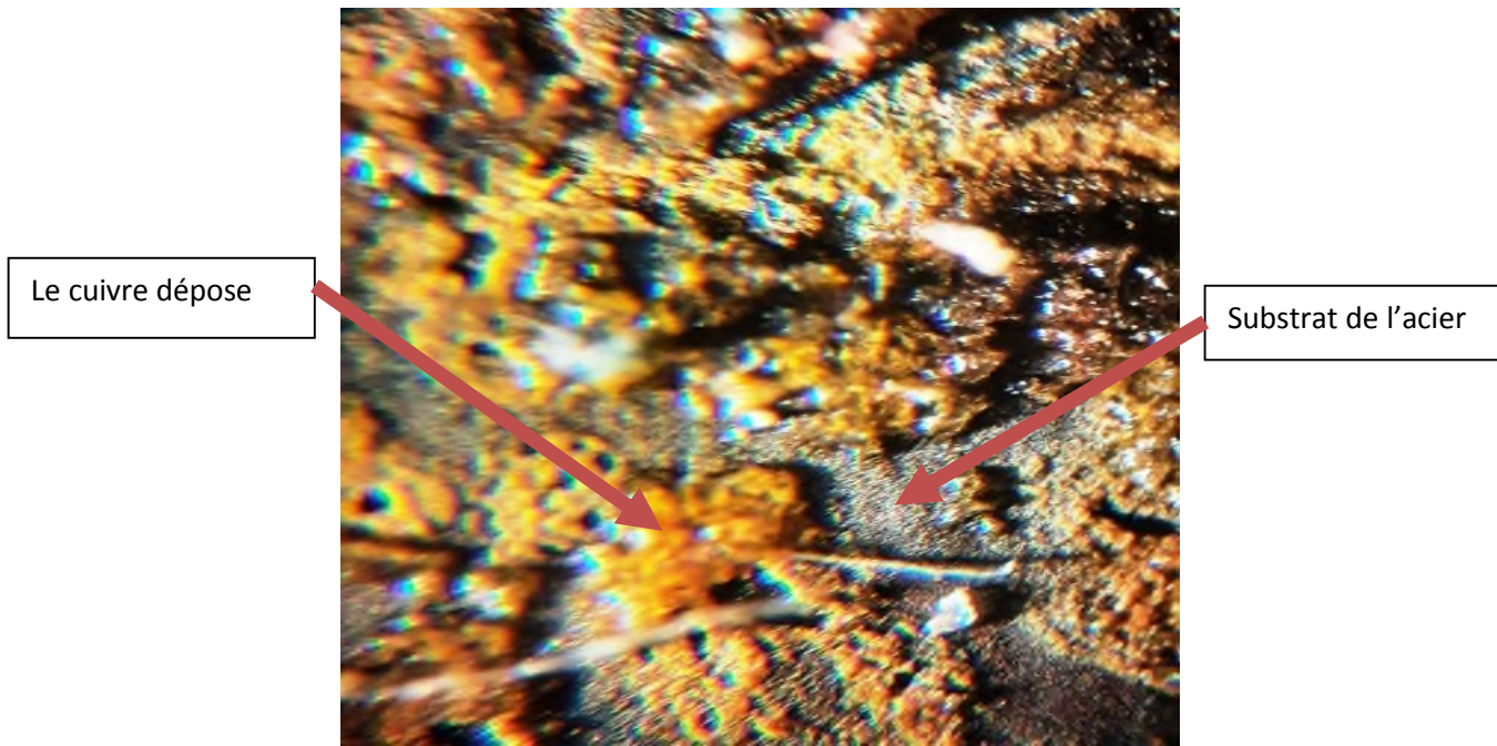
La figure (III.7): dépôt Cu observés par le microscope optique pour V=2,5V .
