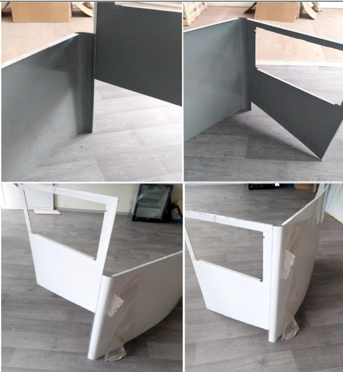
**Figure I.11 : Assemblage par glissement**
