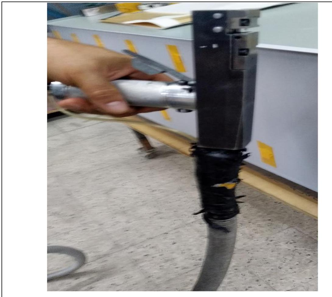
**Figure I.8 : Clincheuse pneumatique**
