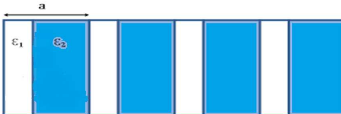
Figure I.4 : Représentation schématique d'un miroir de Bragg constitué de 2 types de couches de permittivité \varepsilon_1 et \varepsilon_2 et la période 'a' [6].
