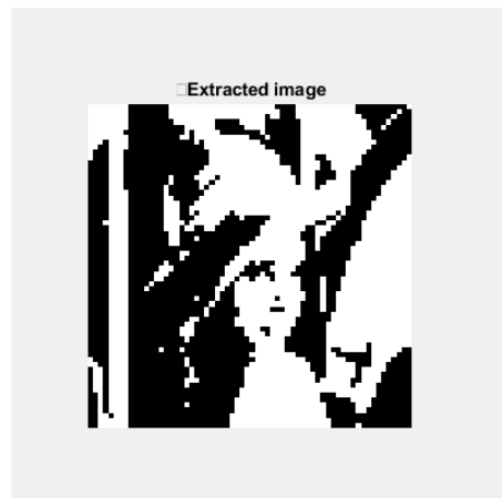
FIGURE III.21 – Tatouage extrait après l'attaque de JPEG com- pression
