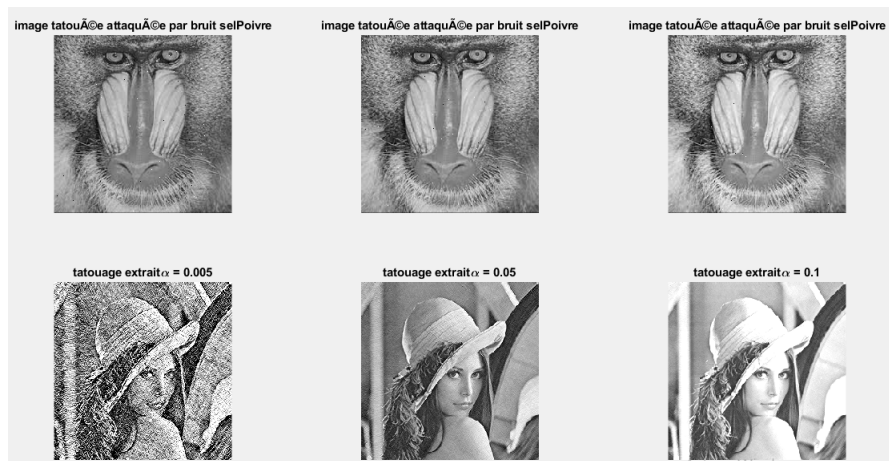
FIGURE III.7 – Images obtenue par ajout de bruit sel et poivre
