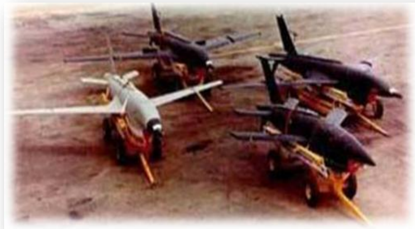
Figure II.4: Différents modèles du Ryan 147 (de gauche à droite : 147J, H, G, NX).
