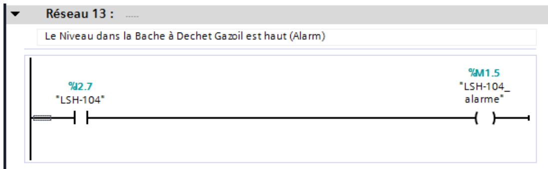
Figure III. 14 : Réseau de signalisation d'alarme au niveau la bache à déchet
