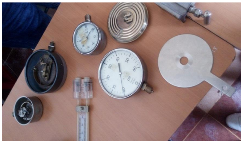
Figure II.11 : Manomètre a pression différentielle (photo prise sur site)
