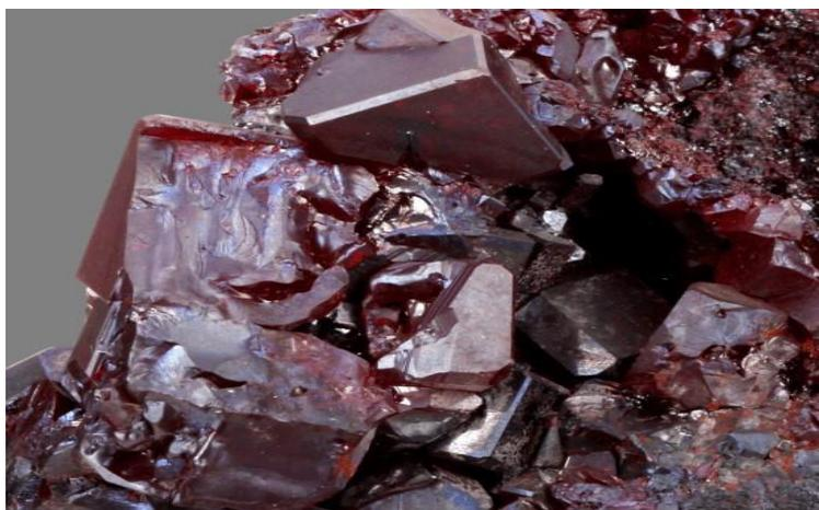
**Figure I.5.** L'oxyde cuivreux ( $\text{Cu}_2\text{O}$ ) sous forme d'un solide cristallin.
