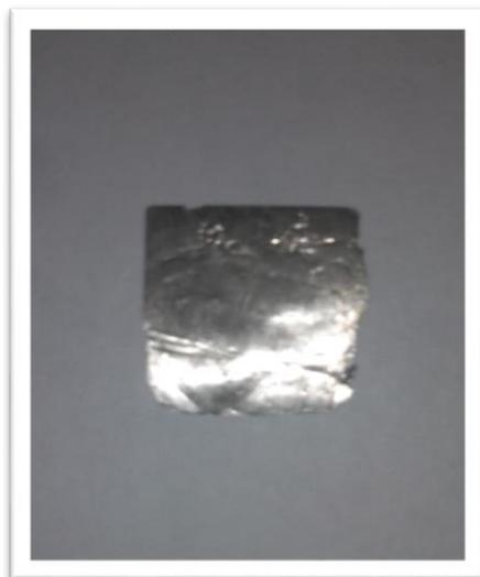
*Figure II.5. Électrode auxiliaire en platine.*
