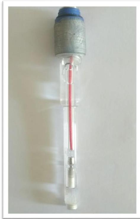
*Figure II.4. Électrode de référence au calomel saturé.*
