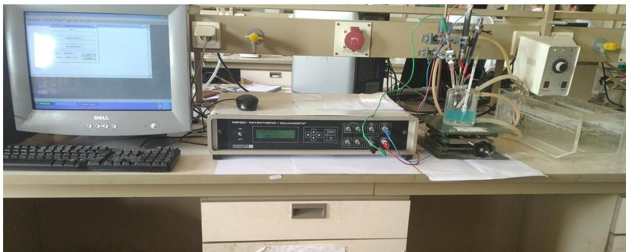
*Figure II.1. Montage global utilisé pour l'électrodéposition de  $\text{Cu}_2\text{O}$ .*
