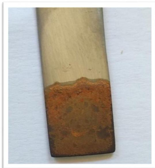
*Figure II.3. Électrode de travail en lame d'acier.*
