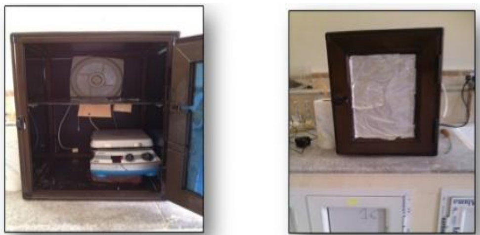
Figure II.5 : Photographie du montage utilisé pour le traitement photo catalytique
