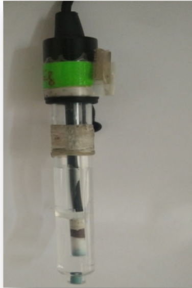
Figure II.3 : Electrode de référence au calomel saturée en chlorure de potassium.
