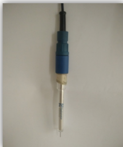
Figure II.4 : Electrode auxiliaire (la contre électrode)
