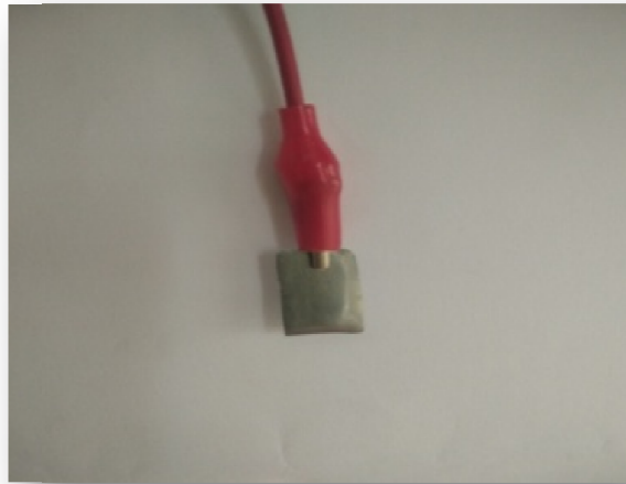
Figure II.5 : Electrode de travail (fil électrique +plaque d'acier).
