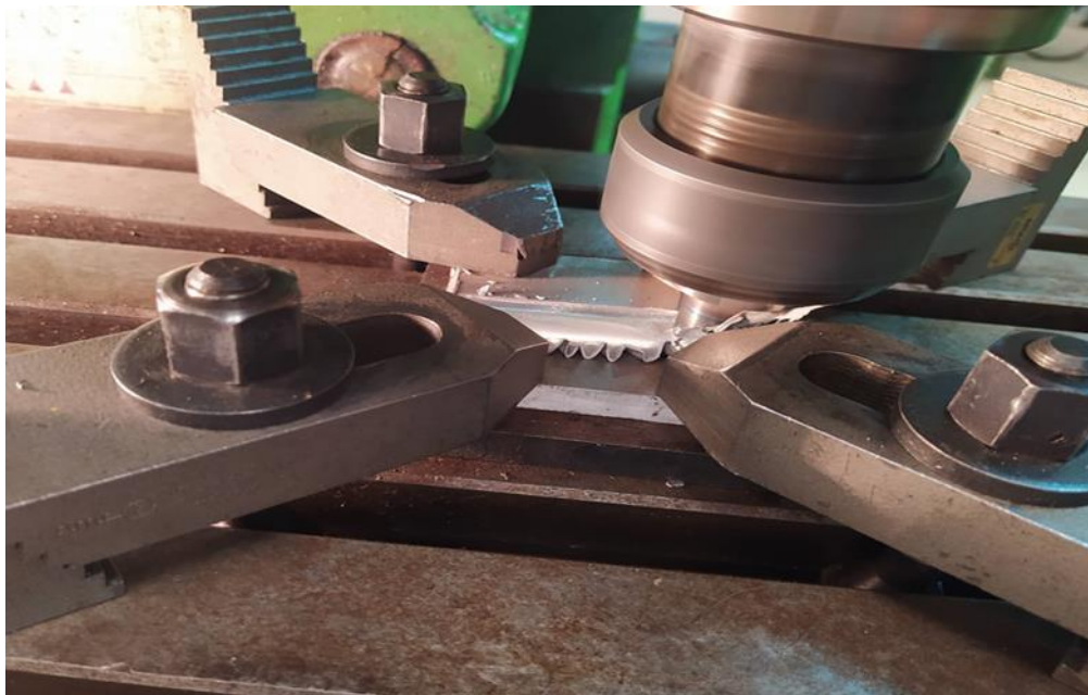
Figure III-4 : Exécution de l'opération de soudage par friction et malaxage.
