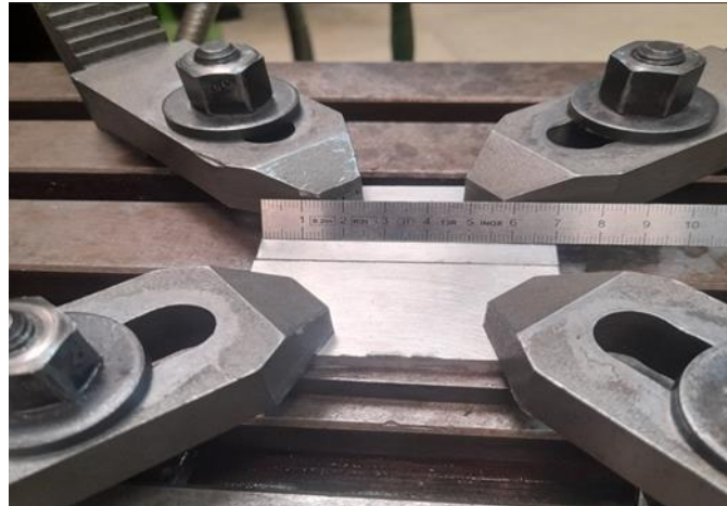
Figure III-2 : Plaques fixées par brides étagées pour un soudage FSW bout à bout.
