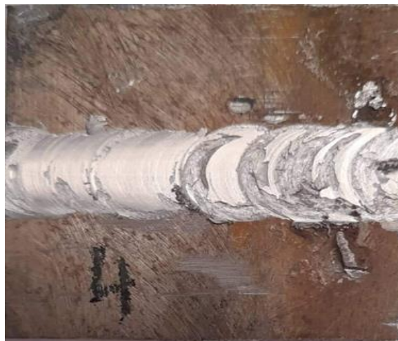
Figure II-13 : Défaut de surface « flash »
