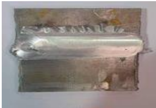
Figure II-15 : Bavures excessives le long du joint (« Dibbon flash »).
