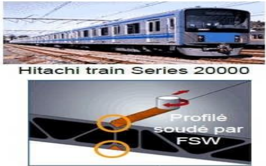
Figure II-11 : Soudage de profilé du train Hitachi [20].
