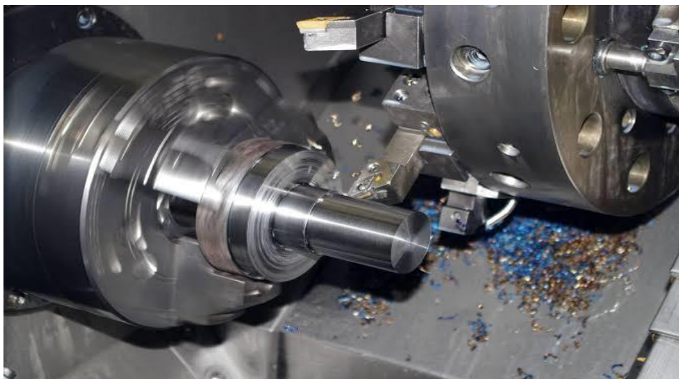
Figure I.04. Usinage d'une pièce cylindrique sur un tour.
