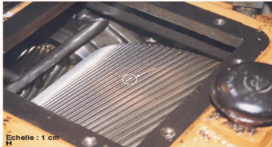
Figure II.10 Photographie de la dent détériorer par écaillage [21]
