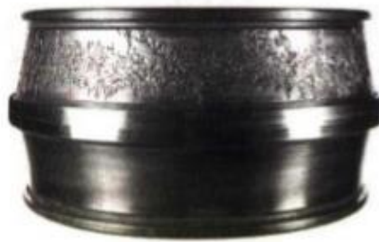
Figure I.11 Défaut de roulement- écaillage [2]
