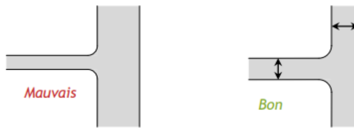
Fig. I-4 : Epaisseurs uniformes et non uniformes.
