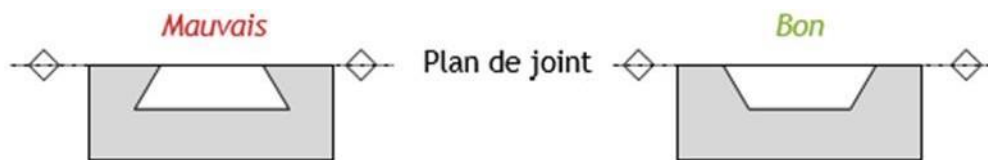
Fig. I-8 : Eviter les contre dépouilles.
