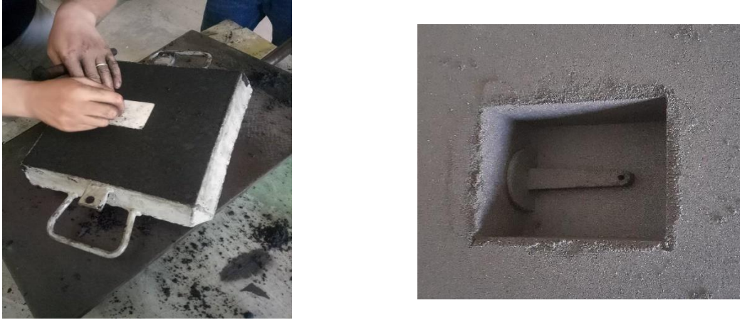
Fig. III-17 : Extraction du modèle et apparition de l'empreinte sur le sable.
