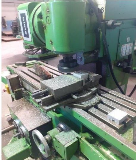
Fig. III-23 : Surfaçage des pièces.
