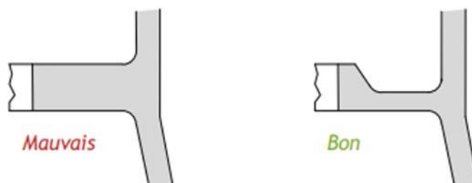
Fig. I-6 : Accumulation de matière et solution.
