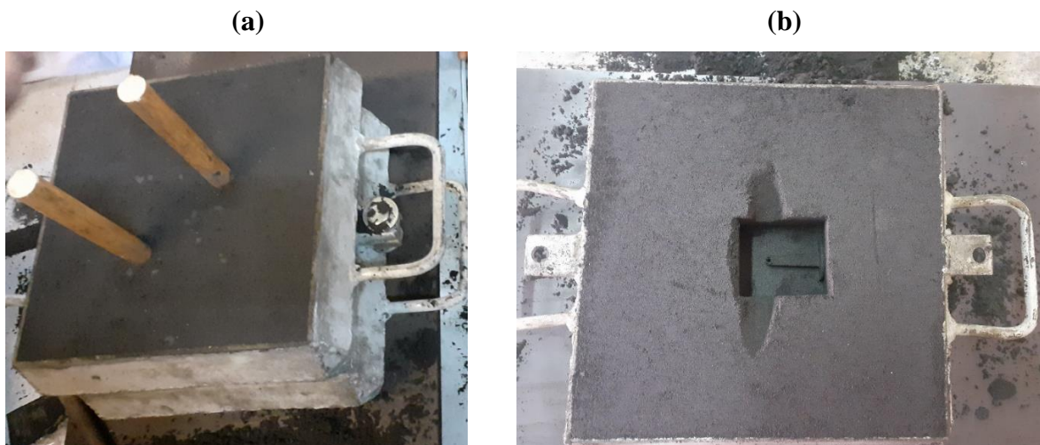
Fig. III-18 : (a) Assemblage des deux châssis avec mandrin de coulée (b) Façonnage du canal d'alimentation et d'évent.
