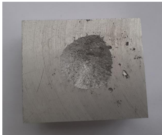
Fig. III-22 : Apparition de la cavité.
