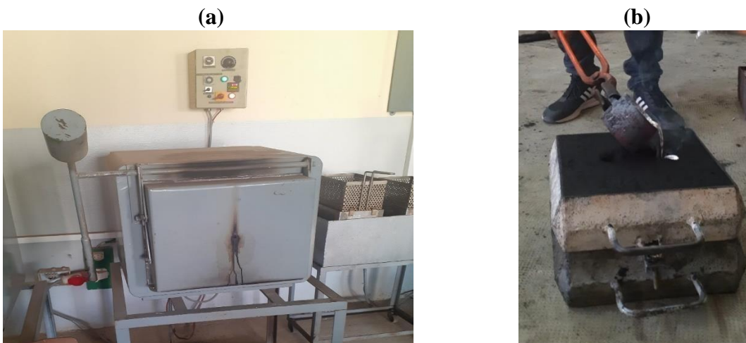
Fig. III-20 : (a) Four utilisé (b) Coulée de l'aluminium.
