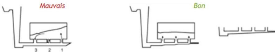
Fig. I-14 : Réduction progressive de la section des canaux.
