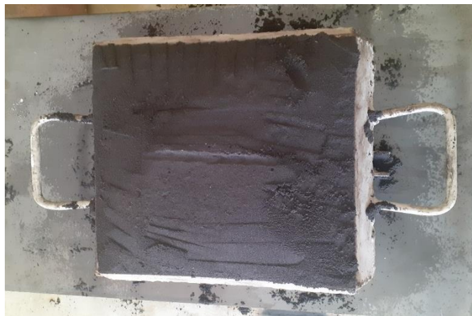
Fig. III-15 : Châssis remplie de sable condensé.
