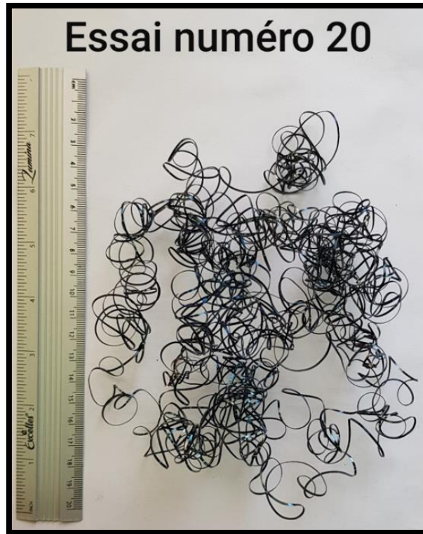
Figure IV. 54 : Copeaux tubulaires enchevêtrés (s'enroulant autour de l'outil ou de la pièce).
