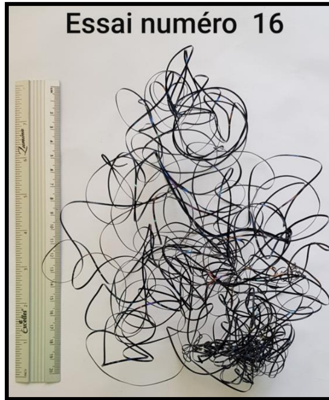
Figure IV. 46 : Copeaux rubans enchevêtrés (s'enroulant autour de l'outil ou de la pièce).
