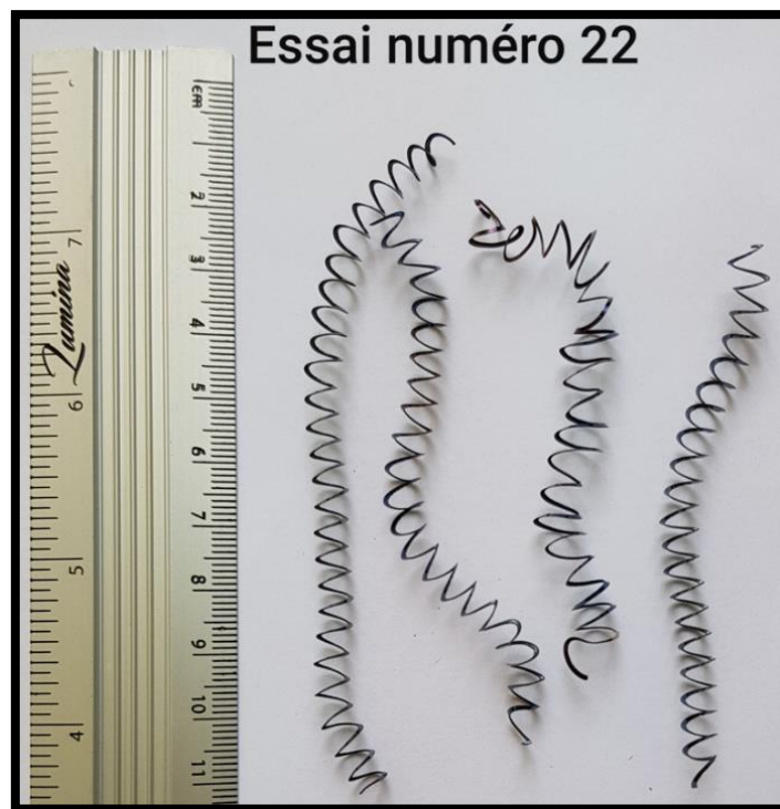
Figure IV. 58 : Copeaux hélicoïdaux en rondelles courts.
