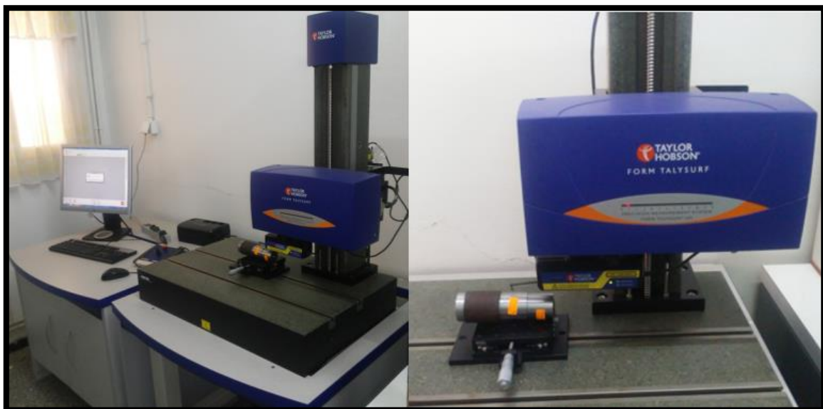
Figure III. 8 : Profilomètre TAYLOR HOBSON FORM TALYSURF 120.
