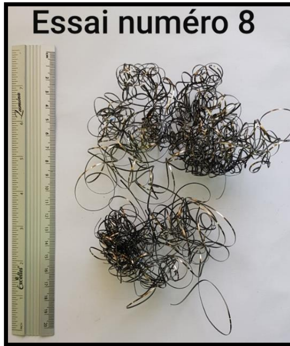
Figure IV. 30 : Copeaux tubulaires enchevêtrés.
