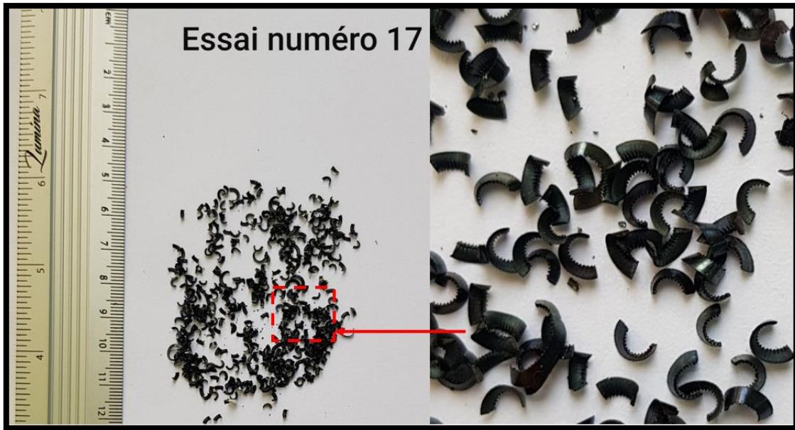
Figure IV. 48 : Copeaux en arcs détachés festonnés.
