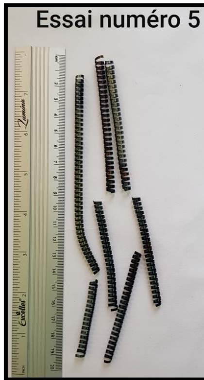
Figure IV. 24 : copeaux hélicoïdaux en rondelles courts.
