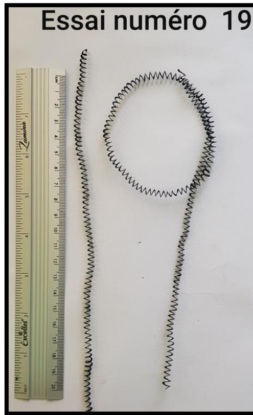
Figure IV. 52 : Copeaux hélicoïdaux en rondelles longs.
