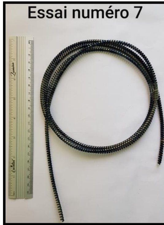
Figure IV. 28 : Copeau hélicoïdal en rondelle long (longueur de 2m).
