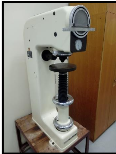
Figure III. 1: Duromètre WOLPERT DIA TESTOR 2 RC.
