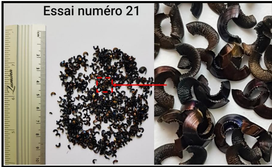
Figure IV. 56 : Copeaux élémentaires détachés festonnés.
