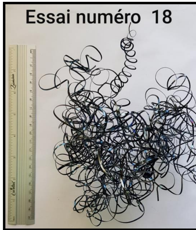
Figure IV. 50 : copeaux hélicoïdaux en rondelles enchevêtrés (s'enroulant autour de l'outil ou de la pièce).
