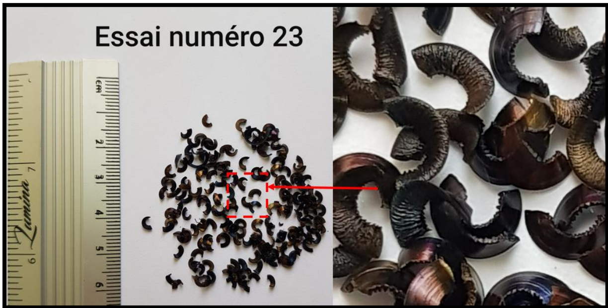
Figure IV. 60 : Copeaux en arcs festonnés.
