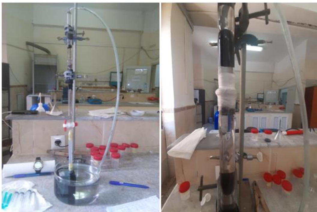
Figure III.5 : Colonne d'adsorption à lit fixe.
