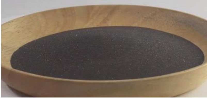
Figure I.2 : Structure de charbon actif en poudre.
