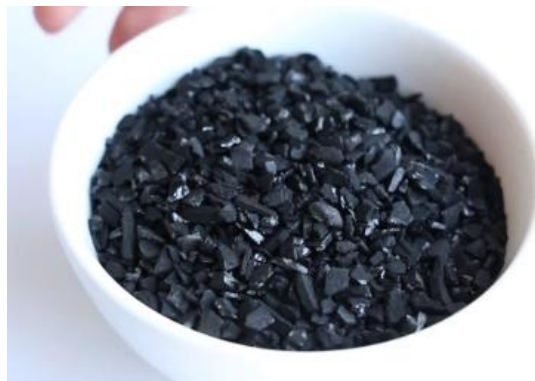
Figure I.1 : La forme de charbon actif granulaire.
