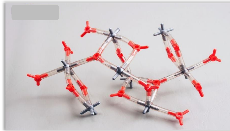
Figure I.5: Structure cristallographique de la brookite (Ti en gris, O en rouge)
