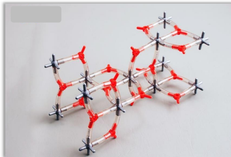
Figure I.4 : Structure cristallographique de l'anatase (Ti en gris, O en rouge)
