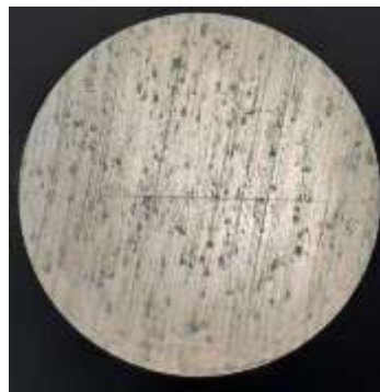
Figure III.1 : Micrographie optique du duralumin (Al-4%Cu) à l'état de livraison (sans traitement thermique) 400X.
