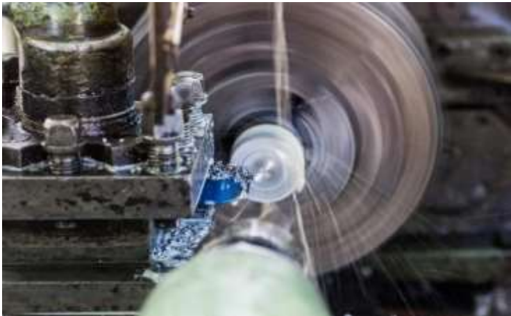
Figure II.2 : préparation l'éprouvette d'essai de dureté.
