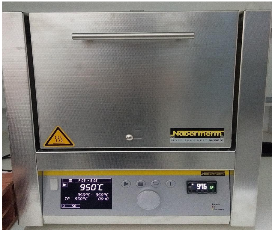
Figure III.2 : four électrique utiliser pour le traitement thermique.
