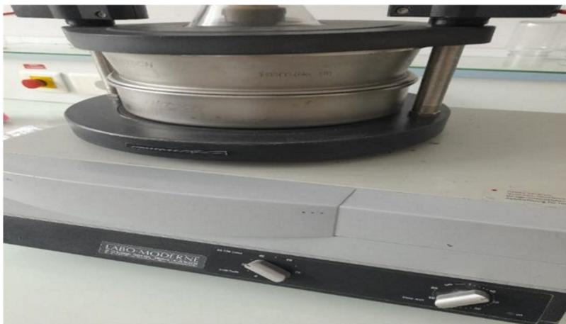
**Figure II.8 :** Tamiseuse utilisée pour les deux bioadsorbant FN et NN.
