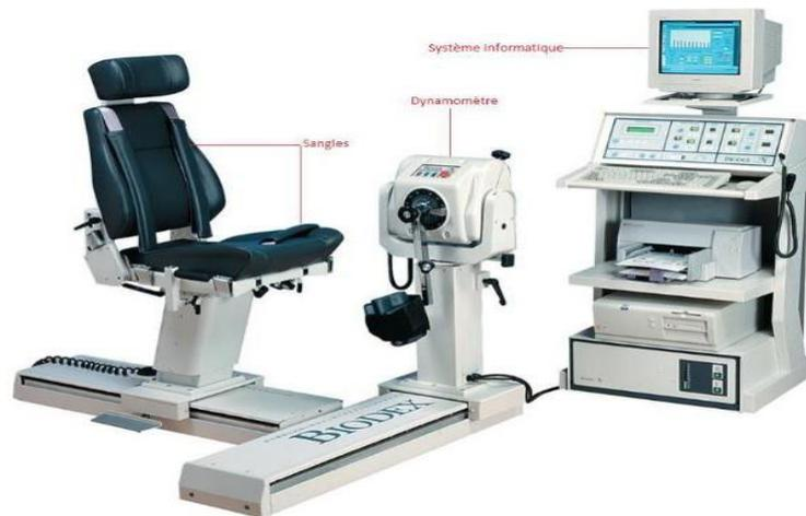
Figure 12 : Appareil isocinétique
