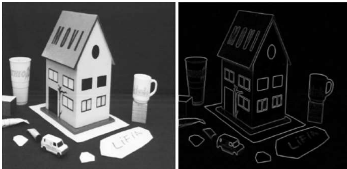
Figure.1 2: Exemple de détection des contours[3]
